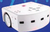
Découvrez le fonctionnement du robot Thymio et programmez-le pour réaliser diverses missions comme détecter des obstacles, changer de couleur ou encore dessiner des formes au sol.
